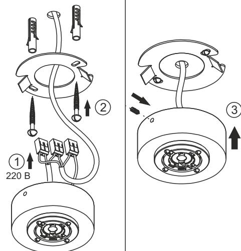
**!** Установка светильника осуществляется при выключеной электрической сети.
