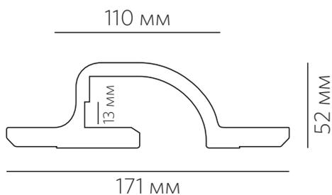
Гипсовый профиль LINEAR GYPSUM предназначен для освещения при помощи интеграции в него светодиодной ленты.
