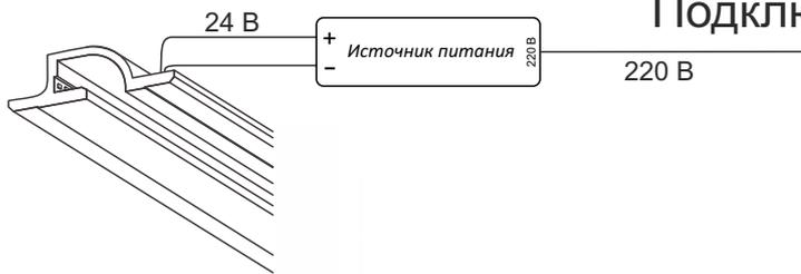
Источник питания устанавливается за пределами корпуса профиля в электромонтажном шкафу
