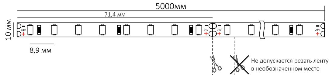
Ленту можно резать строго в указанных местах, между контактными площадками для пайки.
