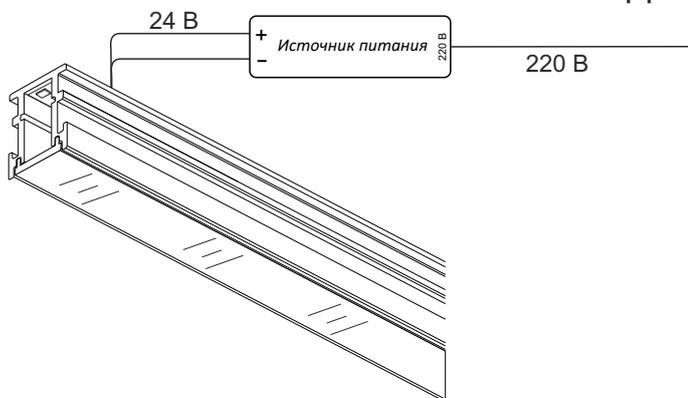
Источник питания устанавливается за пределами корпуса профиля в электромонтажном шкафу, или в специально отведённом месте.
