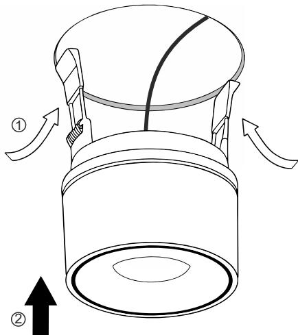
**4** Установка завершена, светильник готов к эксплуатации.
