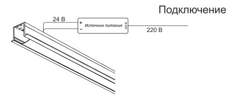
Источник питания устанавливается за пределами корпуса профиля в электромонтажном шкафу, или за потолочным пространством
