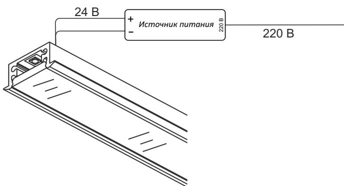
Источник питания устанавливается за пределами корпуса профиля в электромонтажном шкафу, или в специально отведённом месте.
