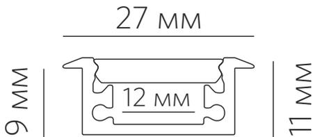
Комплект встраиваемого алюминиевого профиля Linear 2711 Floor предназначен для освещения при помощи интеграции в него светодиодной ленты.
